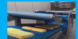
Cámara de descarga abatible lateralmente de fácil acceso para permitir adecuada limpieza, desinfección y mantenimiento
