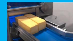
Cámara de corte que permite hasta 3 productos de 100x100mm o 2 con interleaver
